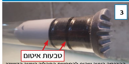
ההדגמה בצנור שקוף להמחשת התהליך בצינור הדיווידג
